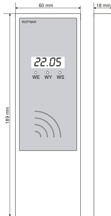
rys3. Czytnik dedykowany RCP78AR - wymiary główne
